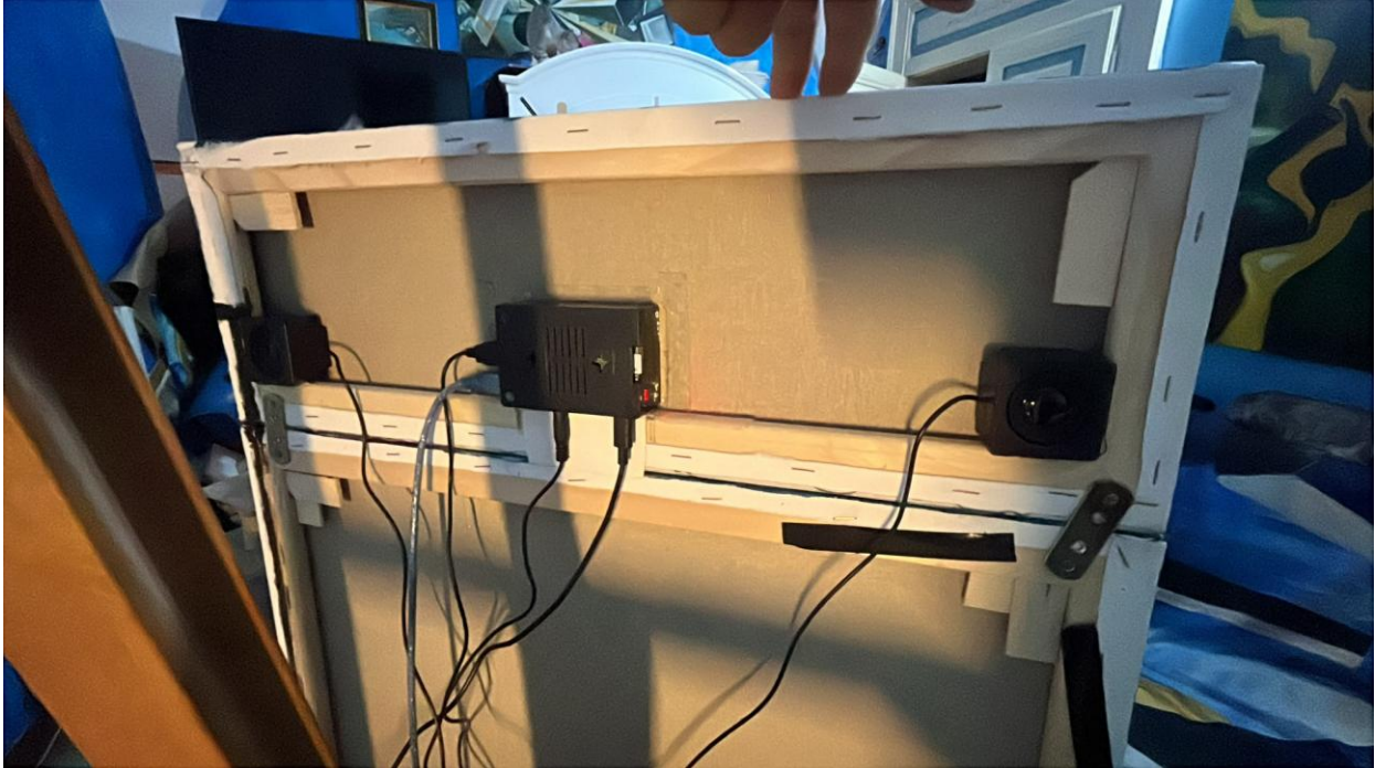
Retro dell'opera nella configurazione finale: Raspberry Pi e diffusori acustici integrati nel telaio.
